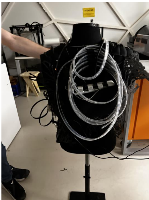
Figura 9 - Montagem da fita de LED nas costas do modelo.
